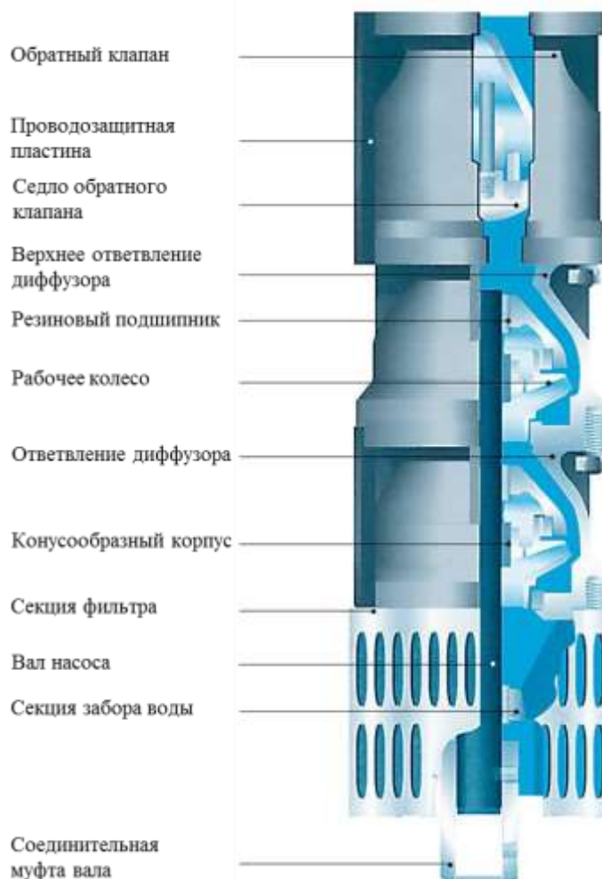
Рисунок 14. Структура насосной части погружного агрегата насосного SJ
